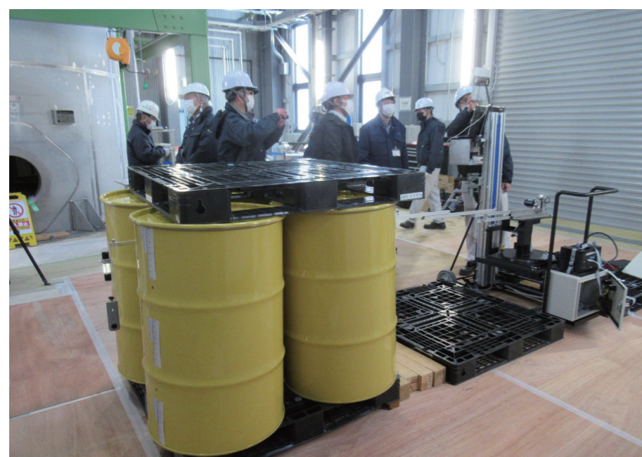
ドラム缶全面外観点検治具の製作
